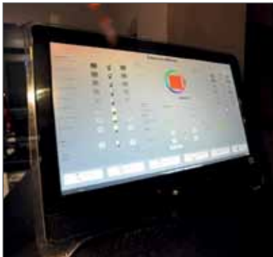
oben: Touchpanel-PC zur Visualisierung, Bedienung, Energieüberwachung, Türkommunikation und Torsteuerung
